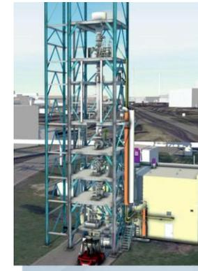
TENOVA e DANIELI: Impianti di implementazione del processo Direct Reduction Iron ENERGIIRON ZR nel quale si utilizza l'idrogeno come agente riducente, l'obiettivo è di realizzare un processo a "0" emissioni di CO<sub>2</sub>
