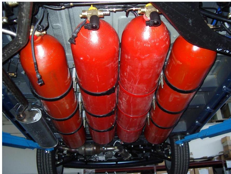
Pacco bombole: necessità di sostituire le bombole originali per evitare il problema dell'infragilimento da idrogeno
